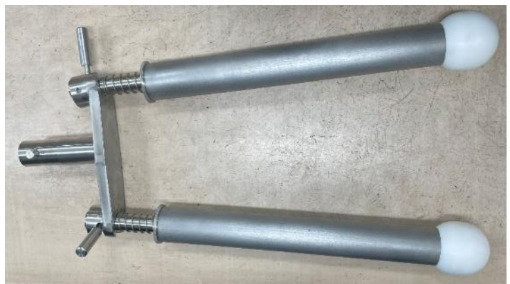
攪拌部品一式製作(ステンレスおよび樹脂)
