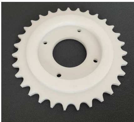
樹脂製スプロケット (規格外歯数、旋盤およびマシニングにて)
