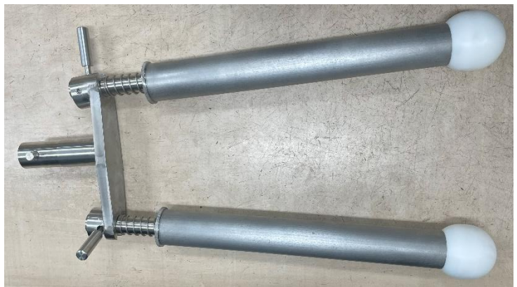
攪拌部品一式製作(ステンレスおよび樹脂) (外国製装置、メーカー対応不可のため採寸して製作)
