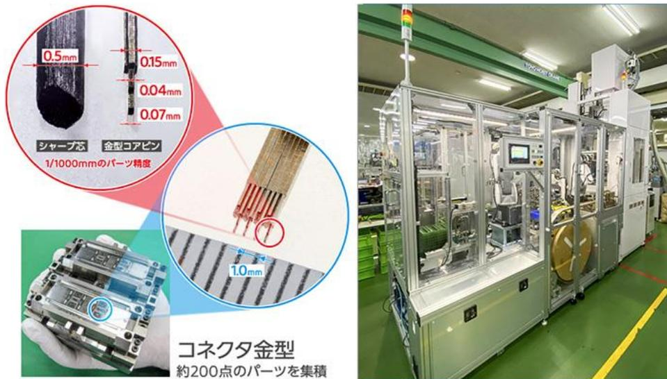
図 4. 精密金型と自動機
